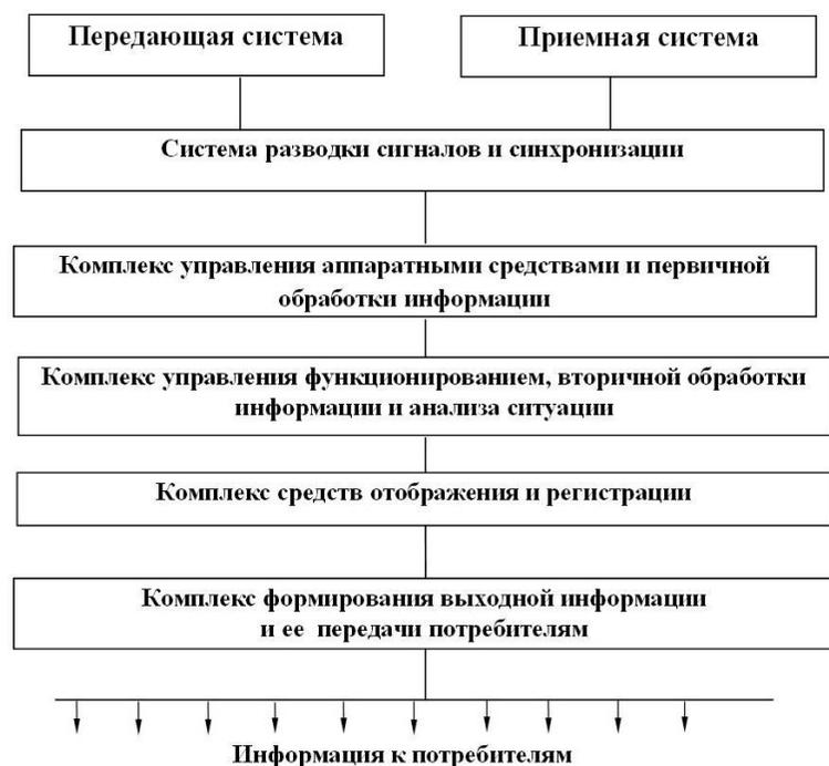
Рис. 1. Структурная схема РЛС
